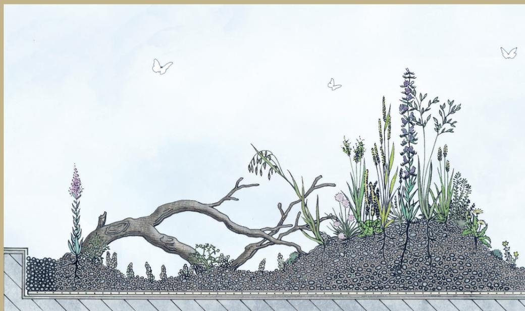
Coupe de principe (hors-échelle) d'une toiture végétalisée extensive, avec micro-topographie et bois sec pour les insectes.
