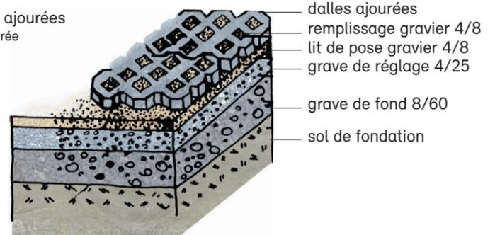
Pavage à joints perméables
